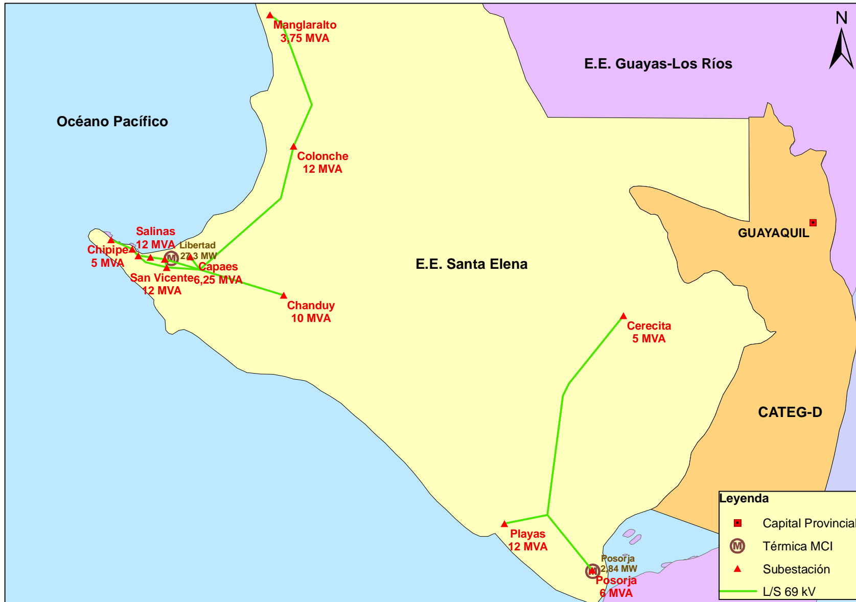
Figura 4-20: Centrales de generación, S/E y líneas de subtransmisión de la E.E. Santa Elena
