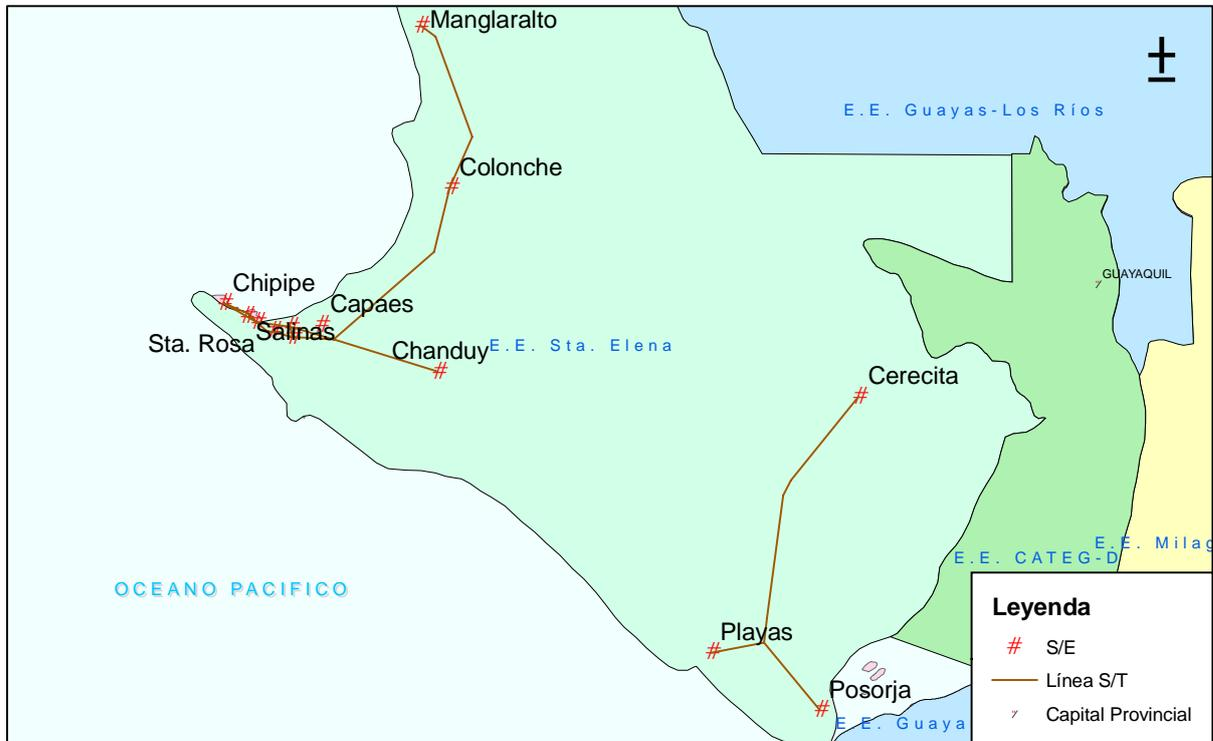
Figura 68. S/E y líneas de subtransmisión en el área de concesión de la E.E. Santa Elena
