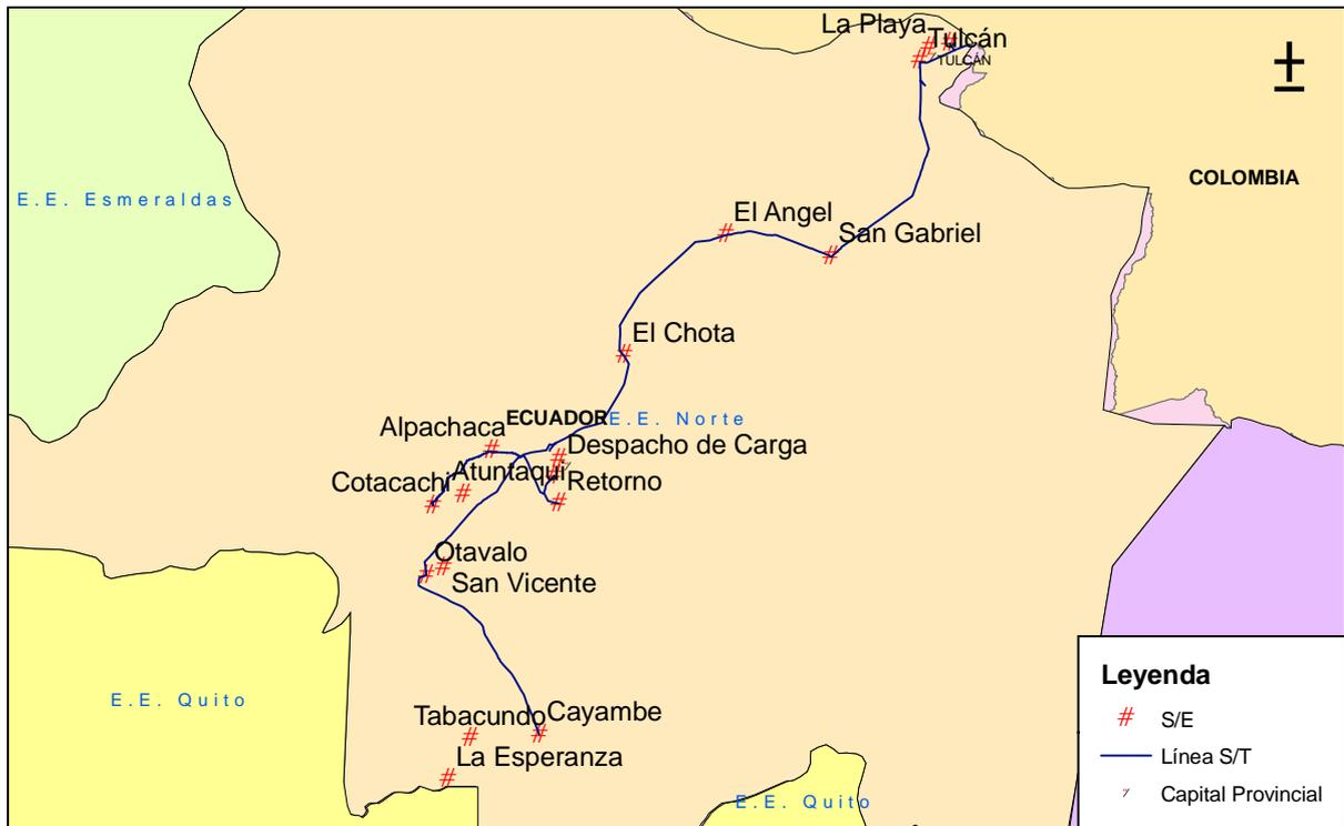
Figura 65. S/E y líneas de subtransmisión en el área de concesión de la E.E. Norte
