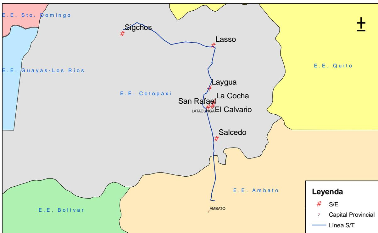
Figura 57. S/E y líneas de subtransmisión en el área de concesión de la E.E. Cotopaxi
