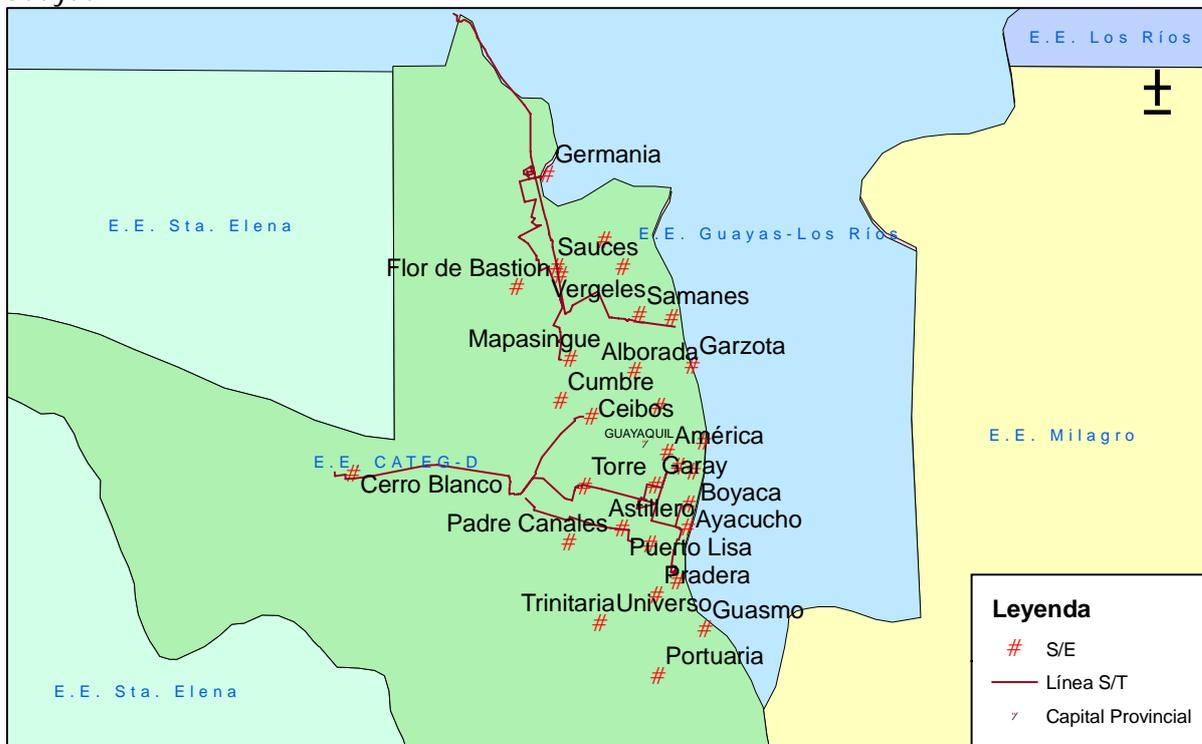
Figura 55. S/E y líneas de subtransmisión en el área de concesión de la CATEG-D
