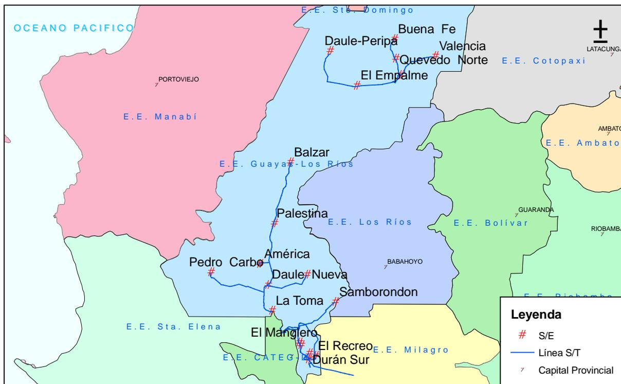
Figura 61. S/E y líneas de subtransmisión en el área de concesión de la E.E. Guayas-Los Ríos
