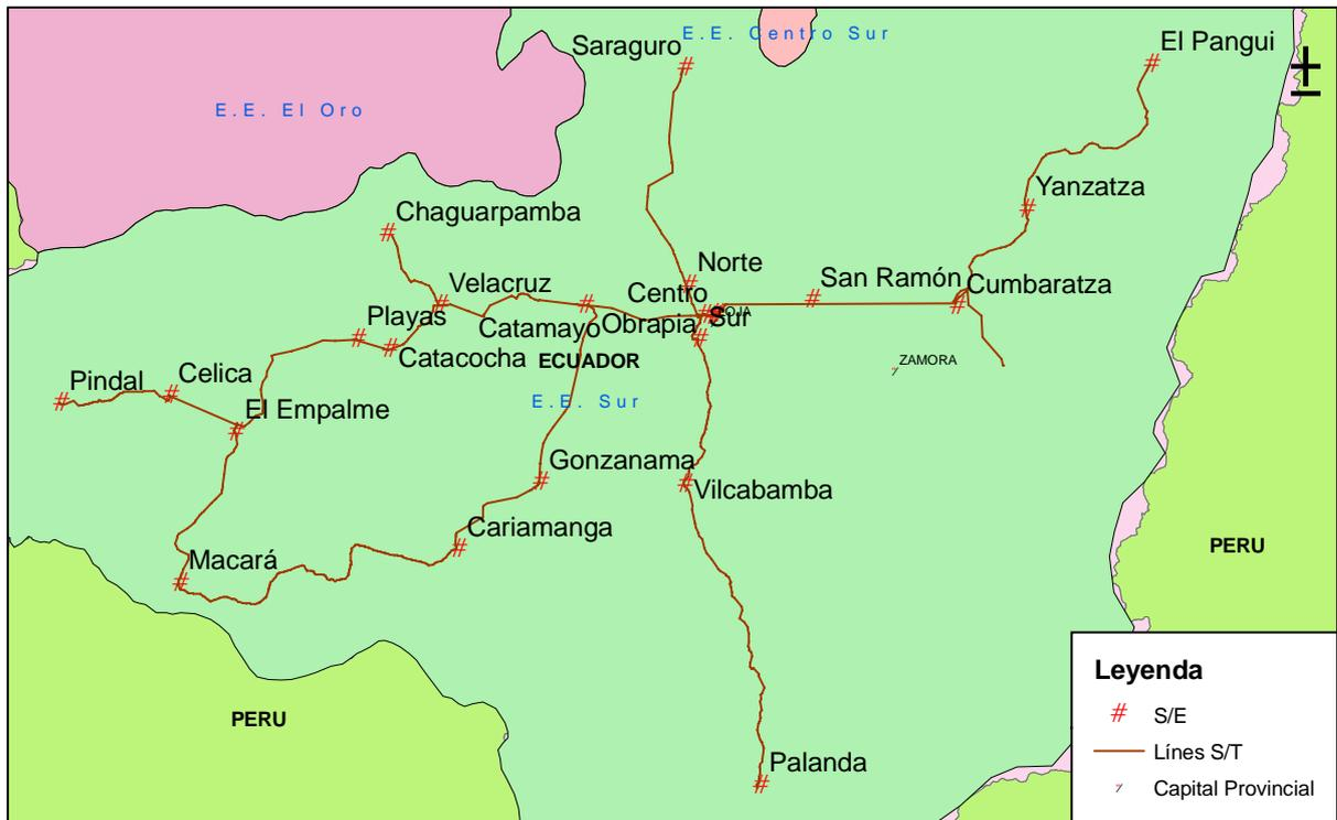
Figura 71. S/E y líneas de subtransmisión en el área de concesión de la E.E. Sur
