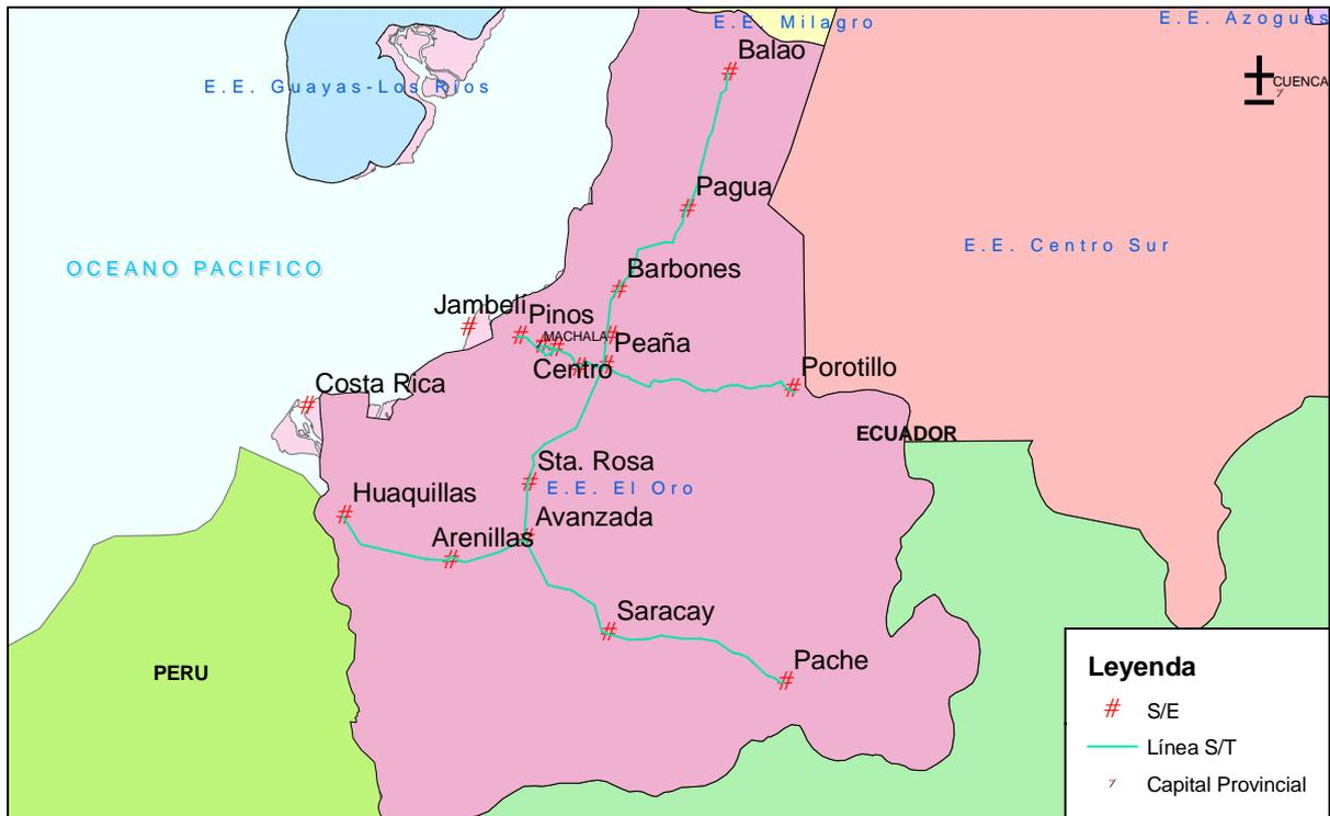
Figura 58. S/E y líneas de subtransmisión en el área de concesión de la E.E. El Oro
