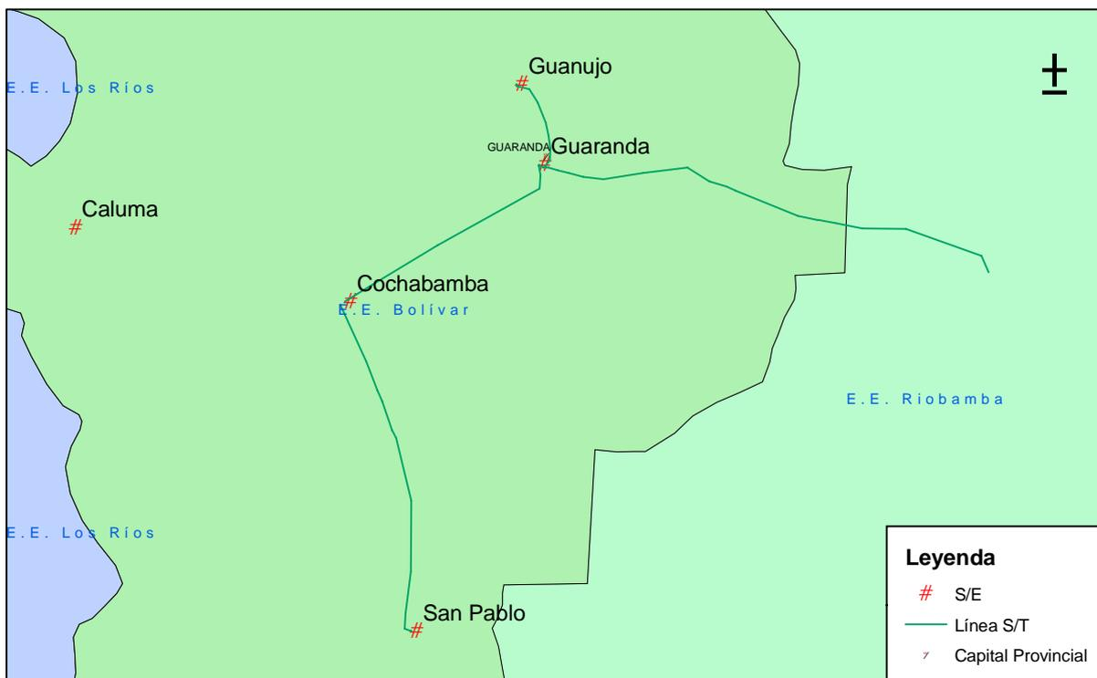
Figura 54. S/E y líneas de subtransmisión en el área de concesión de la E.E. Bolívar
