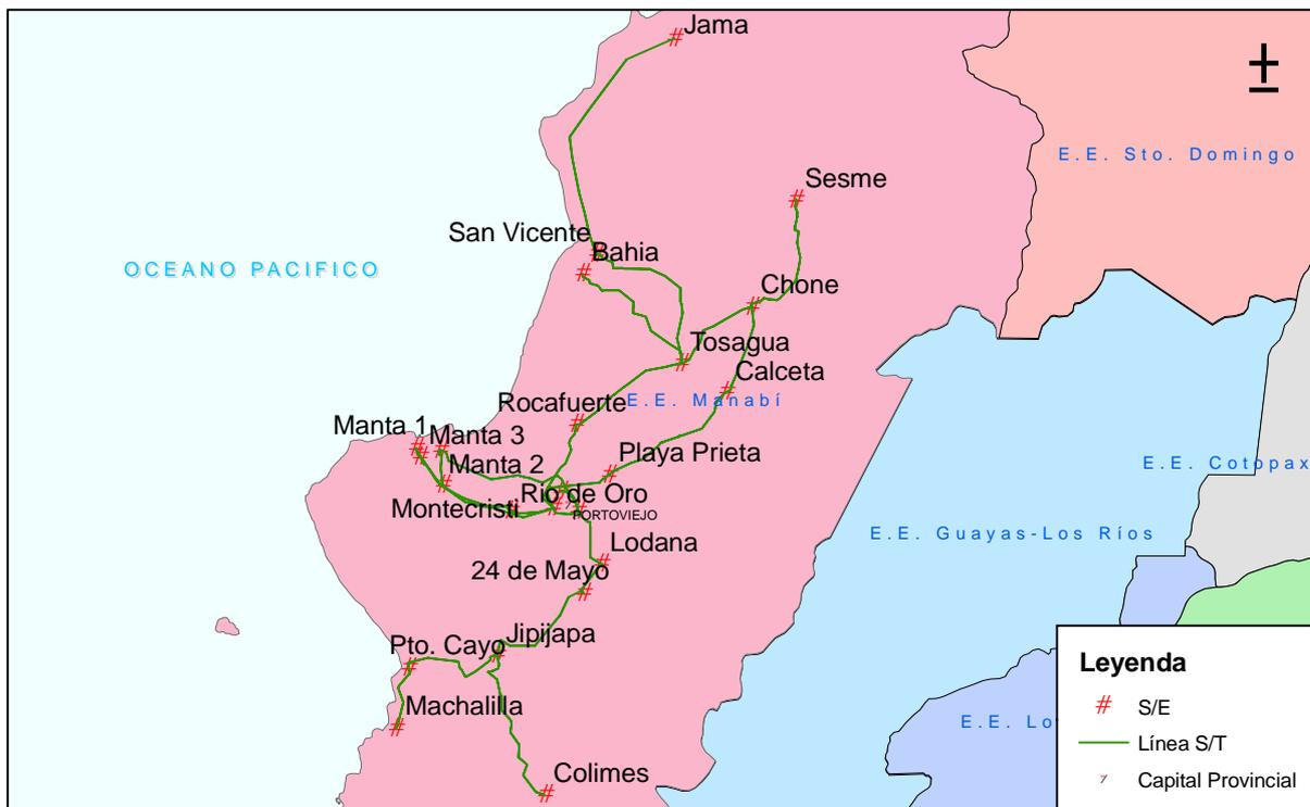
Figura 63. S/E y líneas de subtransmisión en el área de concesión de la E.E. Manabí
