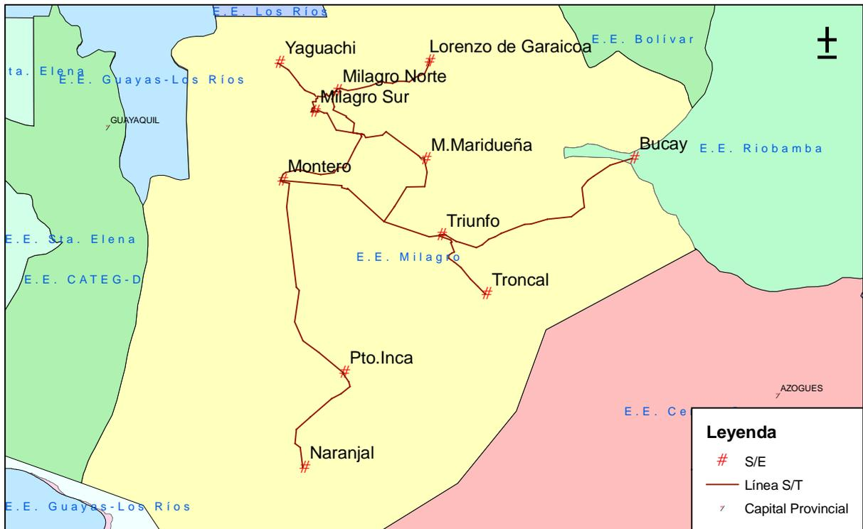
Figura 64. S/E y líneas de subtransmisión en el área de concesión de la E.E. Milagro
