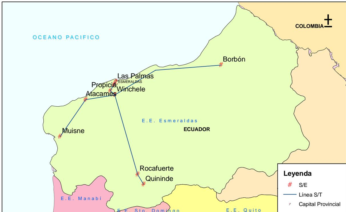
Figura 59. S/E y líneas de subtransmisión en el área de concesión de la E.E. Esmeraldas
