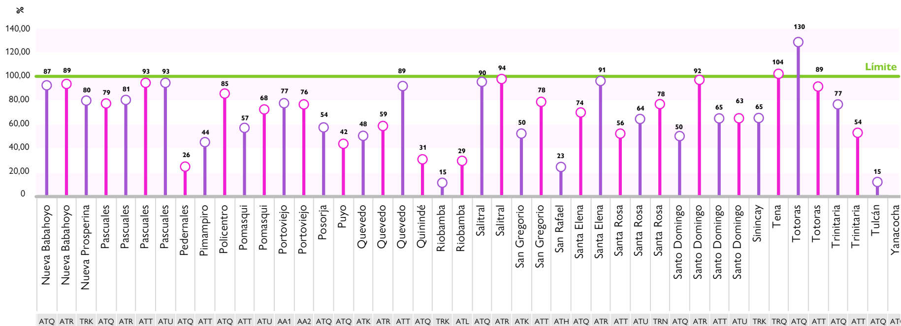
● FIGURA Nro. 84: Nivel de uso de transformadores del SNT (2/2)
